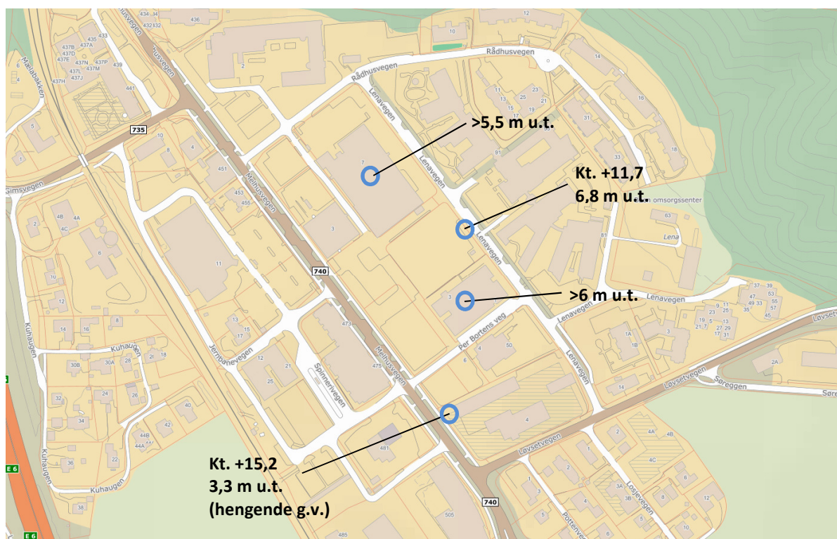
Figur 4-2: Oversikt over grunnvannsmålinger i og rundt planområdet
